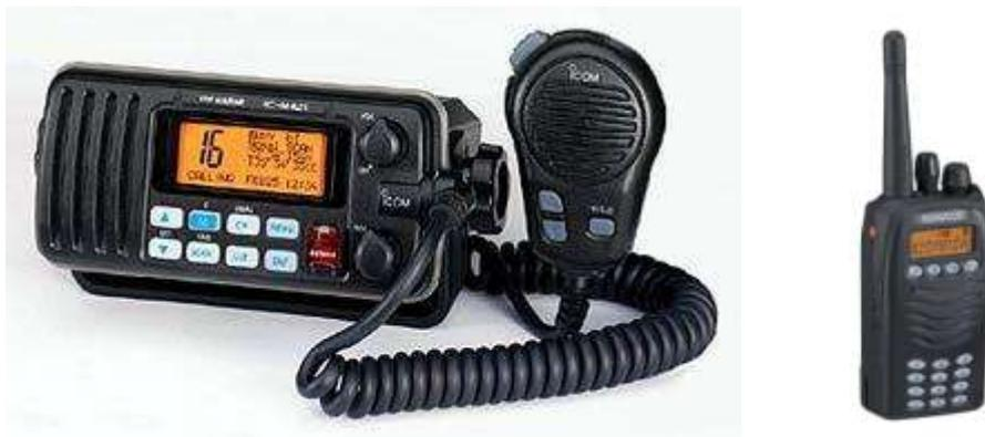
Figura 2. Un apparato VHF fisso e uno portatile.
